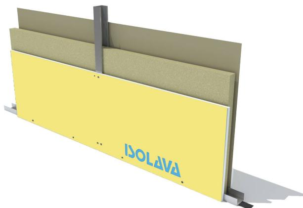
Cloison de distribution constituée par assemblage de deux plaques BA18 Haute Dureté NF Isolava de largeur 1200 mm, vissées sur une ossature métallique de 70 mm.
