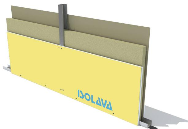
Cloison de distribution constituée par assemblage de deux plaques BA18 Haute Dureté NF Isolava de largeur 900 mm, vissées sur une ossature métallique de 70 mm.
