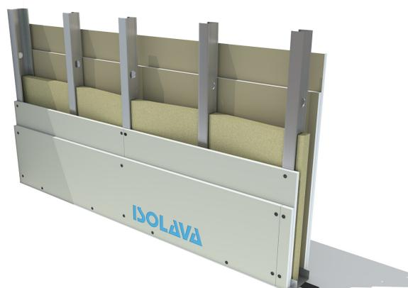
Cloison de séparation constituée par assemblage de deux plaques BA13 NF Isolava de chaque côté de largeur 1200 mm, vissées sur une ossature métallique de 48 mm alternée et positionnée dans un rail de 70 mm.
