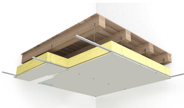
Plafond constitué par assemblage d'une ou plusieurs plaques de plâtre NF Isolava, vissées sur fourrures F47.
