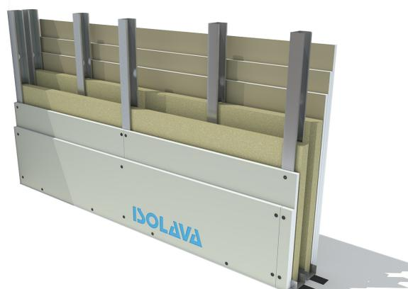
Cloison de séparation réalisée en montage dissymétrique, constituée par assemblage de 1 x 2 plaques BA13 NF Isolava sur une face et de 1 x 3 plaques BA13 NF Isolava sur l'autre face de largeur 1200 mm, vissées sur une double ossature métallique de 48 mm positionnée dans un rail de 48 mm.
