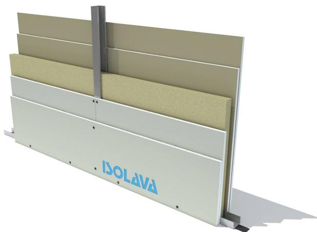
Cloison de distribution constituée par assemblage de deux plaques BA13 NF Isolava de chaque côté de largeur 600 ou 1200 mm, vissées sur une ossature métallique de 100 mm.
