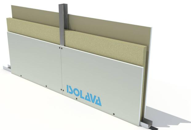
Cloison de distribution constituée par assemblage de deux plaques BA13 NF Isolava de largeur 600 ou 1200 mm, vissées sur une ossature métallique de 48 mm.
