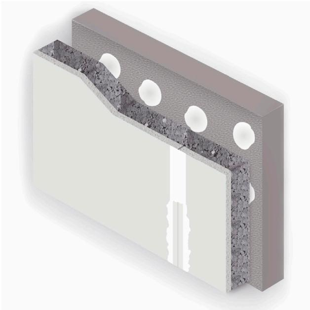
Complexes de doublages thermiques et thermo-acoustiques se présentant sous forme de panneaux, constitués de plaques de plâtre Isolava standards et techniques et d'un panneau de polystyrène expansé standard ou graphité. Conductivité thermique 0,030, 0,032 ou 0,038 W/m.K.
