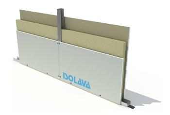
Cloison de distribution constituée par assemblage de deux plaques BA15 NF Isolava de largeur 1200 mm, vissées sur une ossature métallique de 100 mm.
