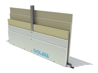
Cloison de distribution constituée par assemblage de deux plaques BA13 NF Isolava de chaque côté de largeur 600 ou 1200 mm, vissées sur une ossature métallique de 48 mm.
