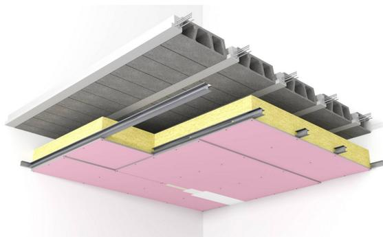
Plafond constitué par assemblage d'une ou plusieurs plaques de plâtre FIREprotect NF Isolava, vissées sur une ossature métallique, en autoportant.
