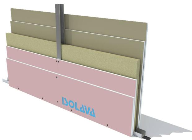
Cloison de distribution constituée par assemblage de deux plaques BA13 FIREprotect NF Isolava de chaque côté de largeur 1200 mm, vissées sur une ossature métallique de 90 mm.
