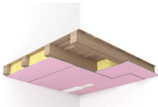
Plafond constitué par assemblage de deux plaques de plâtre BA13 FIREprotect NF Isolava, fixation directe sous plancher bois avec laine de roche impérative.
