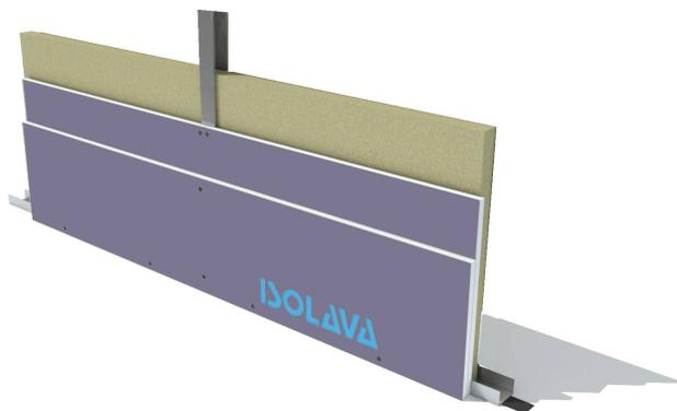
Contre-cloison constituée par assemblage de deux plaques BA13 STARprotect R' NF Isolava sur la même face de largeur 1200 mm, vissées sur des montants métalliques, avec ou sans isolant, en fonction des performances à obtenir.
