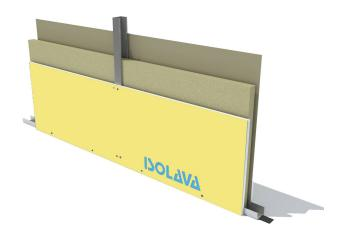
Cloison de distribution constituée par assemblage de deux plaques BA18 Haute Dureté NF Isolava de largeur 900 mm, vissées sur une ossature métallique de 100 mm.
