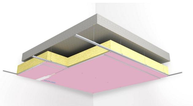
Plafond constitué par assemblage de deux plaques de plâtre BA15 FIREprotect NF Isolava, vissées sur fourrures F47.
