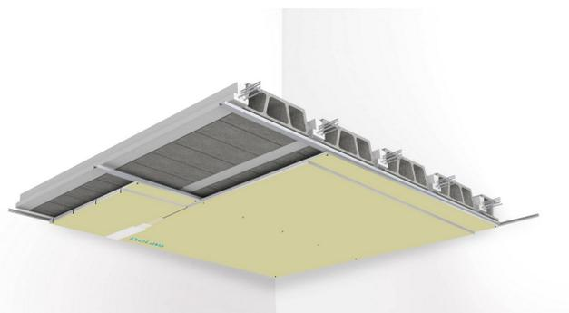
Plafond constitué par assemblage d'une ou deux plaques de plâtre BA18 Haute Dureté NF Isolava, vissées sur fourrures F47.
