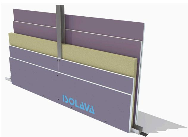
Cloison de distribution constituée par assemblage de deux plaques BA13 STARprotect R' NF Isolava de chaque côté de largeur 600 ou 1200 mm, vissées sur une ossature métallique de 48 mm.
