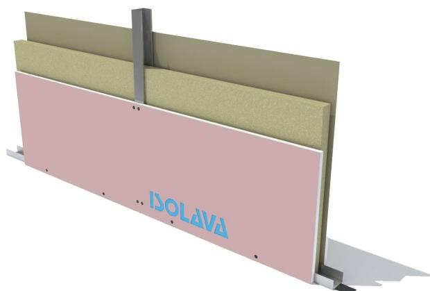
Cloison de distribution constituée par assemblage de deux plaques BA13 FIREprotect NF Isolava de largeur 1200 mm, vissées sur une ossature métallique de 48 mm.
