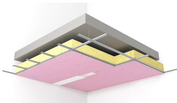
Plafond constitué par assemblage d'une plaque de plâtre BA15 FIREprotect NF Isolava, vissées sur une ossature en croix F47. Montage avec connecteur RF.
