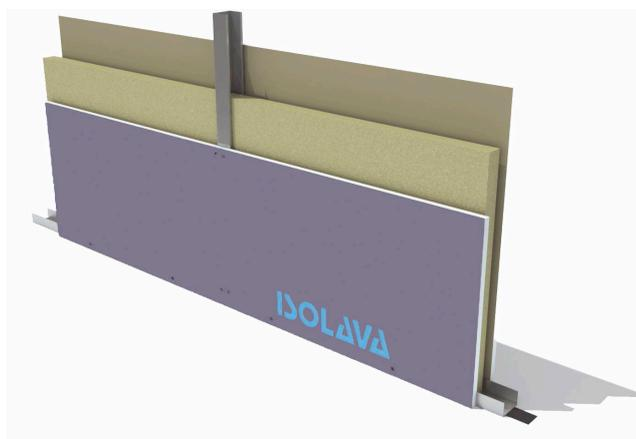
Cloison de distribution constituée par assemblage de deux plaques BA13 STARprotect R' NF Isolava de largeur 600 ou 1200 mm, vissées sur une ossature métallique de 48 mm.
