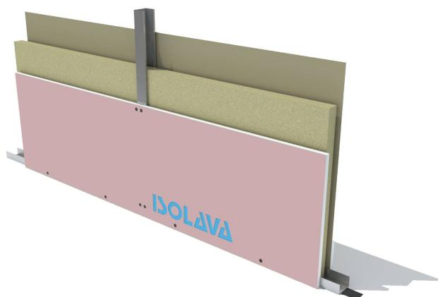
Cloison de distribution constituée par assemblage de deux plaques BA15 FIREprotect NF Isolava de largeur 1200 mm, vissées sur une ossature métallique de 70 mm.
