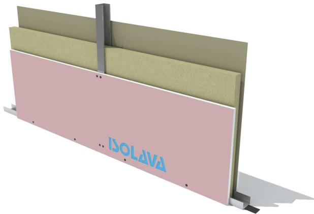
Cloison de distribution constituée par assemblage de deux plaques BA15 FIREprotect NF Isolava de largeur 1200 mm, vissées sur une ossature métallique de 90 mm.
