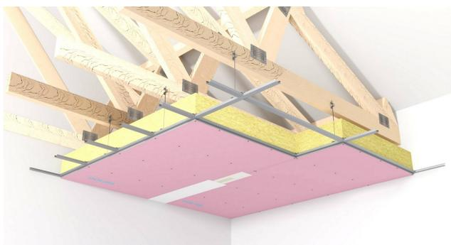
Plafond constitué par assemblage d'une ou plusieurs plaques de plâtre FIREprotect NF Isolava, vissées sur une ossature en croix F47. Montage avec connecteur RF.
