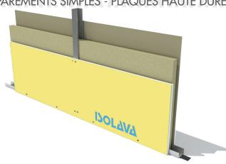
Cloison de distribution constituée par assemblage de deux plaques BA18 Haute Dureté NF Isolava de largeur 900 mm, vissées sur une ossature métallique de 70 mm
