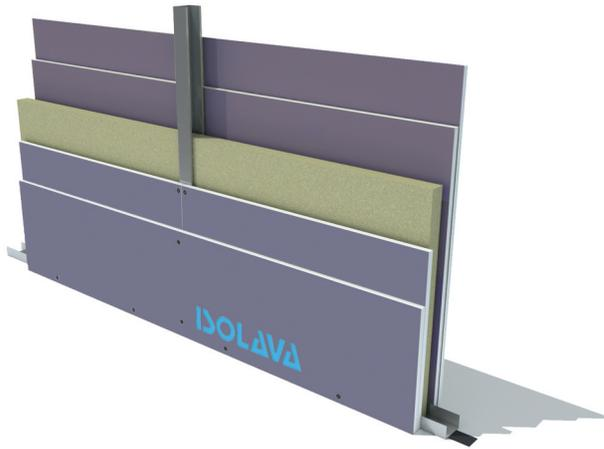
Cloison de distribution constituée par assemblage de deux plaques BA13 STARprotect R' NF Isolava de chaque côté de largeur 600 ou 1200 mm, vissées sur une ossature métallique de 70 mm.
