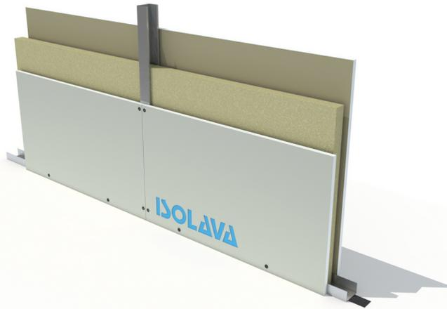
Cloison de distribution constituée par assemblage de deux plaques BA15 NF Isolava de largeur 1200 mm, vissées sur une ossature métallique de 100 mm.
