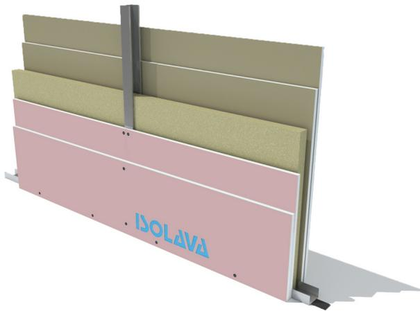
Cloison de distribution constituée par assemblage de deux plaques BA13 FIREprotect NF Isolava de chaque côté de largeur 1200 mm, vissées sur une ossature métallique de 100 mm.
