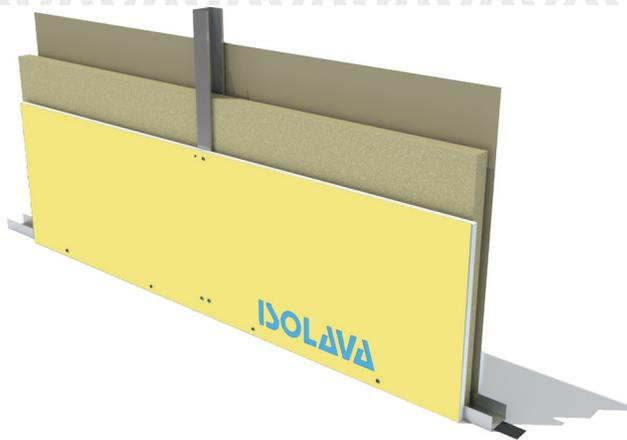
Cloison de distribution constituée par assemblage de deux plaques BA18 Haute Dureté NF Isolava de largeur 900 mm, vissées sur une ossature métallique de 48 mm.
