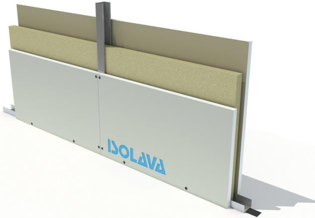
Cloison de distribution constituée par assemblage de deux plaques BA13 FIREprotect NF Isolava de chaque côté de largeur 1200 mm, vissées sur une ossature métallique de 48 mm.
