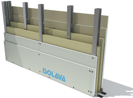
Cloison de séparation constituée par assemblage de deux plaques BA13 NF Isolava de chaque côté de largeur 1200 mm, vissées sur une double ossature métallique de 48 mm positionnée dans un rail de 48 mm.
