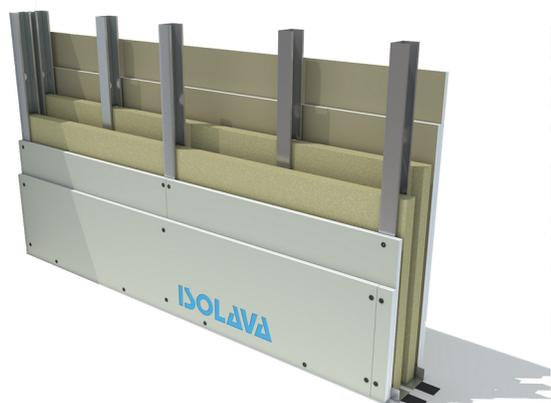
Cloison de séparation constituée par assemblage de deux plaques BA13 NF Isolava de chaque côté de largeur 1200 mm, vissées sur une ossature métallique de 90 mm alternée et positionnée dans des cornières métalliques.
