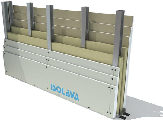
Cloison de séparation constituée par assemblage de trois plaques BA13 NF Isolava de chaque côté de largeur 1200 mm, vissées sur une double ossature métallique de 48 mm positionnée dans un rail de 48 mm.
