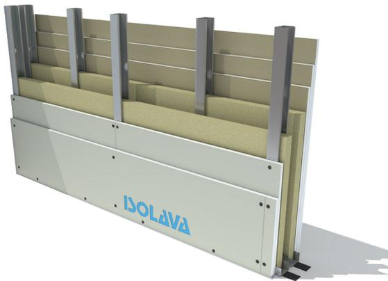
Cloison de séparation réalisée en montage dissymétrique, constituée par assemblage de 1 x 2 plaques BA13 NF Isolava sur une face et de 1 x 3 plaques BA13 NF Isolava sur l'autre face de largeur 1200 mm, vissées sur une double ossature métallique de 48 mm positionnée dans un rail de 48 mm.
