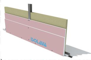
Contre-cloison constituée par assemblage de deux plaques BA13 FIREprotect NF Isolava sur la même face de largeur 1200 mm, vissées sur des montants métalliques, avec ou sans isolant, en fonction des performances à obtenir.
