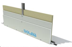
Contre-cloison constituée par assemblage d'une ou deux plaques BA13 NF Isolava sur la même face de largeur 1200 mm, vissées sur des montants métalliques, avec ou sans isolant, en fonction des performances à obtenir.
