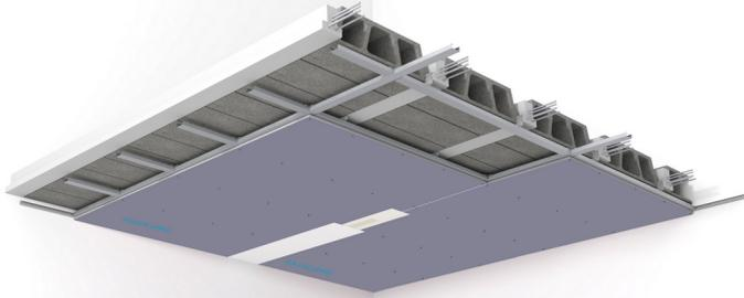
Plafond constitué par assemblage de deux plaques de plâtre BA13 STARprotect R' NF Isolava, vissées sur une ossature en croix F47. Montage avec connecteur RF.
