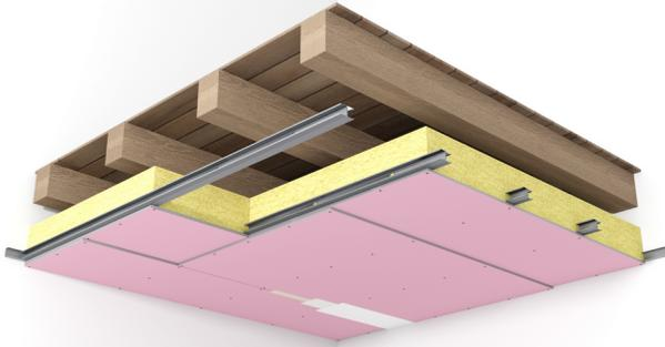
Plafond constitué par assemblage de deux plaques de plâtre BA13 FIREprotect NF Isolava sur double montant métallique en autoportant.
