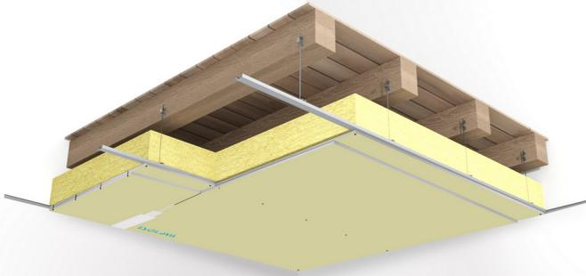
Plafond constitué par assemblage d'une ou deux plaques de plâtre BA18 Haute Dureté NF Isolava, vissées sur fourrures F47.
