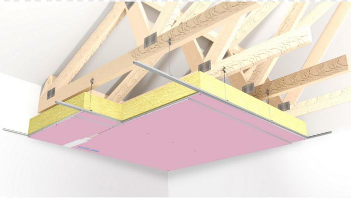
Plafond constitué par assemblage de deux plaques de plâtre BA15 FIREprotect NF Isolava, vissées sur fourrures F47.
