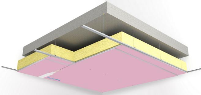
Plafond constitué par assemblage de deux plaques de plâtre BA15 FIREprotect NF Isolava, vissées sur fourrures F47.
